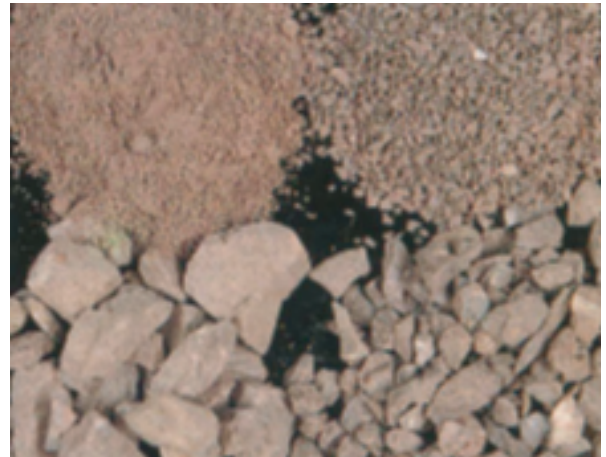
Les granulats : sable et marbre concassé
