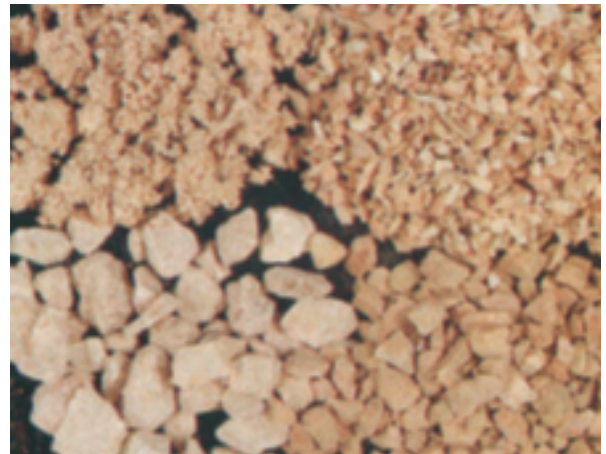
Les granulats : sable et marbre concassé
